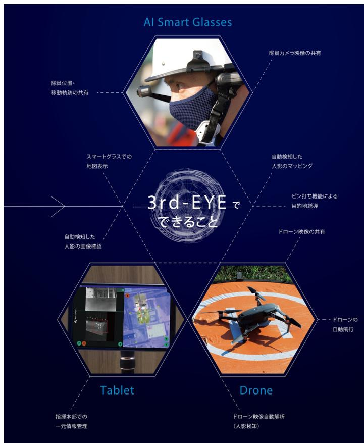
図6 3rd-EYE(スマートグラス・AI・ドローンを使用した情報共有システム)
